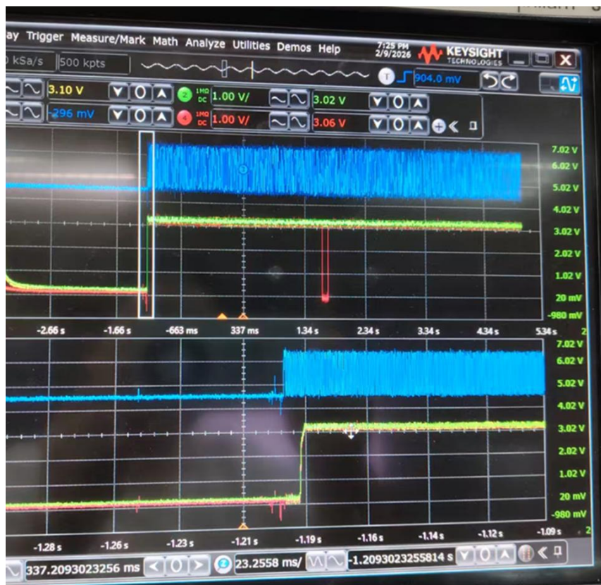
Blue: CLKREQ0# (pin 53), Red: PERST0# (pin 52), Green: WL_REG_ON(3.3V) (pin 56), Yellow: 3.3V(pin 2, 4, 72, 74)
